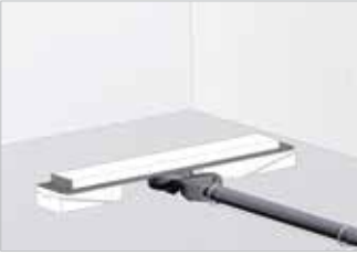
Duş kanalını tesisata bağlayınız ve koruyucu straforu tıkanmaya karşı üzerine koyunuz. Connect the shower channel to the installation and put the protective styropor on top in case of blockage.
