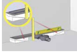
Yükseklik ayar setini zemin kotuna göre terazi ile ayarlayınız. Her kademe 2 mmdir. Adjust height adjusting set with scale according to the ground level. Each step is 2mm.
