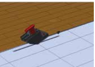
Koruyucu kapağı çıkararak yükseklik ayar parçasını kotunu terazi ile her noktadan ayarlayınız. / Remove the protective styropor and adjust the level the gradual parts with scale from each point.
