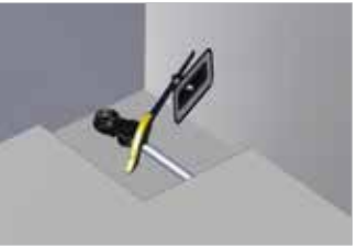
Koruyucu straforu çıkararak seramik gövde arası mesafeyi ölçünüz. Gereken yükseklığe göre çerçeveyi kenarda bulunan işaretlerden kesiniz. Remove the protective styropor and measure the blank between ceramic tile.
