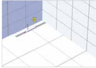
Seramik uygulamasını kapak genişliğinde tamamlayarak net kapak uzunluk ölçüsünü belirleyiniz. Finishing the ceramic application. After determine the net cover sizes.
