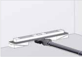
Duş kanalını tesisata bağlayınız ve koruyucu straforu tıkanmaya karşı üzerine koyunuz. Connct the shower channel to the installation and put the protective styropor on ti in case of blockage..
