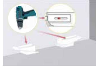
Yükseklik ayar setini sabitlemek için kanal içinden delik açınız. Make a hole from the inside of channel to fix height adjusting sets
