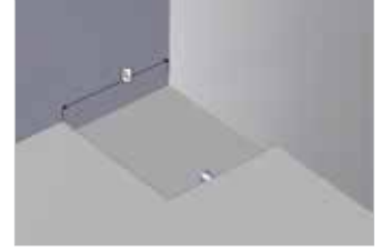
Uygulama yapılacak alanı ölçünüz Belirleyerek toz ve artıklardan arındırınız. Setting the size and cleaning the shower area from powder and waste.
