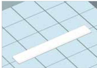
Seramik uygulaması tamamlanana kadar koruyucu stroforu çıkarmayınız. Do not remove the protective styropor until the ceramic application is completed.
