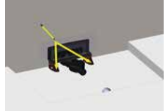
İşaretili yerlerden matkapla delerek dubeli yerleştiriniz. Make a hole with drill from marked points and place the dowel.
