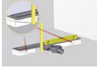
Yükseklik ayar setini zemin kotuna göre terazi ile ayarlayınız. Her kademe 2 mmdir. Adjust height adjusting set with scale according to the ground level. Each step is 2mm.
