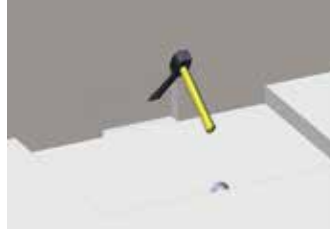
Yatayda 30 cm dikeyde 14 cm derinlik 6 cm boşluk açınız. Open spaces. Horizontal 30 cm, vertical 14 cm, depth 6 cm
