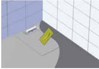
Seramik yapıştırıcısını alana yayınız. Spread the ceramic adhesive to the surface.
