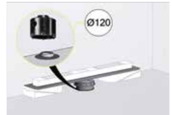
Alt çıkış bağlantısı için kat betonunu karot ile min 120 mm çapında kesiniz. Drill the concrete with the help of drilling core for the pipe connection.
