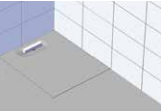
Koruyucu kapak tüm aşamalarda takılı olmalıdır. Protective cover should be installed at all stages.
