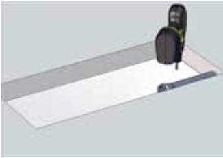
Yüksek ayar setini sabitlemek için kanal içinden delik açınız Make a hole from the inside of channel to fix height adjusting sets.
